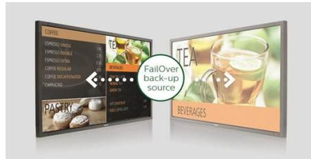
常にコンテンツを表示しておくことは、商用サイネージにとっては非常に重要なことです。フェイルオーバー機能は、万が一メディアプレイヤー側に障害が発生した場合でも、365 日いつでもバックアップコンテンツの再生を可能にします。事前にプライマリ入力とフェイルオーバー入力を選択しておくだけで、プライマリ入力に障害が発生した場合に、自動的にフェイルオーバー入力のバックアップコンテンツの再生を開始します。
